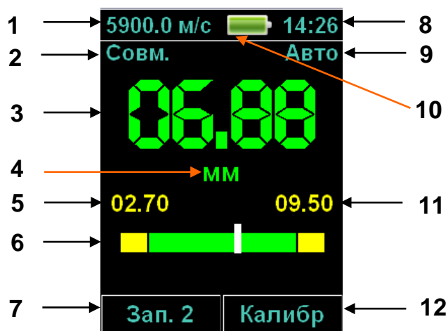
Рисунок 2 - Вид дисплея в режиме цифровой индикации
